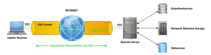
SSH kann es uns ermöglichen einen Login per Login-Credentials durchzuführen. Es kann auch so konfiguriert werden, dass es nur Verbindungen zulässt, mit welchen ein Schlüsselpaar erzeugt wurde. Damit können nur Rechner auf die Maschine zugreifen, wenn der Rechner im Besitz eines Schlüssels ist. Das kann bspw. mittels RSA - Rivest-Shamir-Adleman umgesetzt werden.
