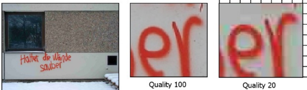
Abbildung 4.9: Illustration von JPEG-Kompressionsartefakten für libJPEGs Qualitätsstufen 100 und 20.
